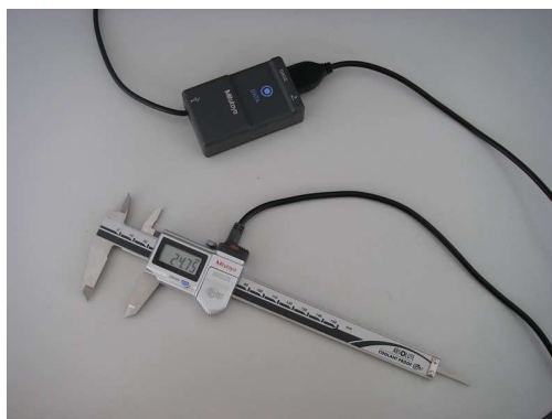
Figure 4 : Pied à coulisse relié à l'ordinateur via « l'input tool »
